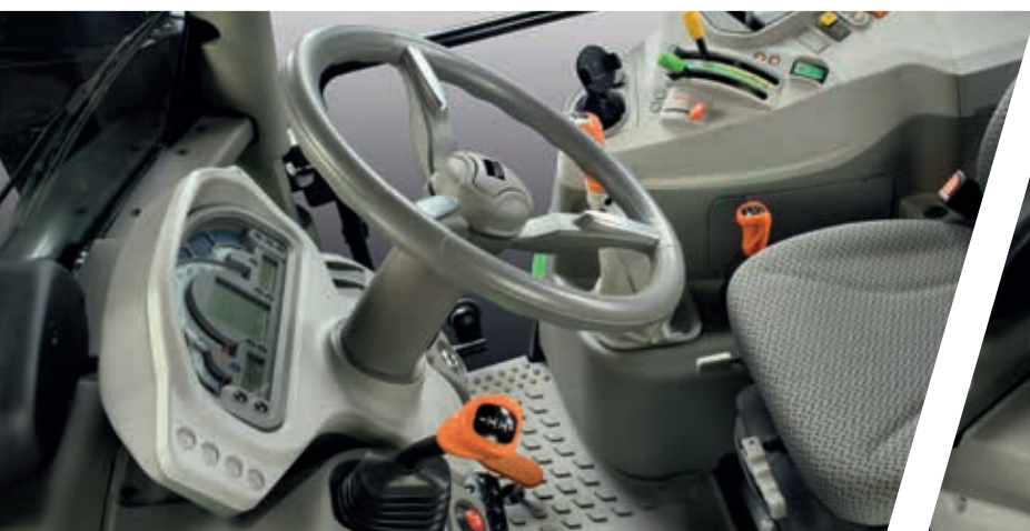
> Inverseur mécanique avec levier ergonomique sur la colonne de direction.
