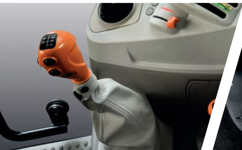
> Levier de vitesse ergonomique avec commandes des Powershift et ComfortClutch.
