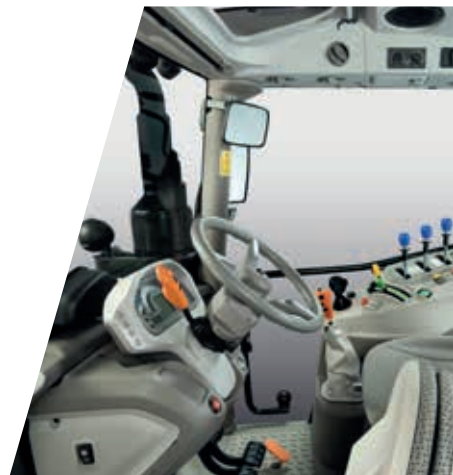
> Cabine à 4 montants pour une meilleure visibilité.
