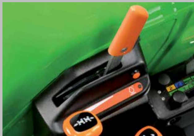
Réglage électronique du régime moteur. Excellent confort lors du travail de routine.
