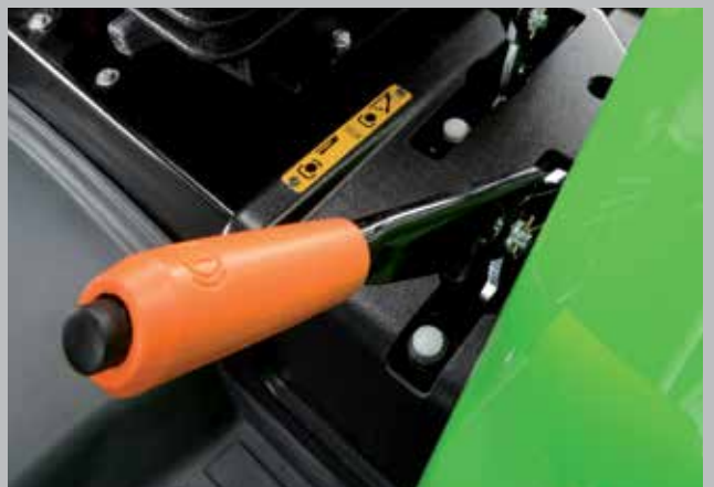
Frein de stationnement mécanique installé à portée de main à côté du siège conducteur.
