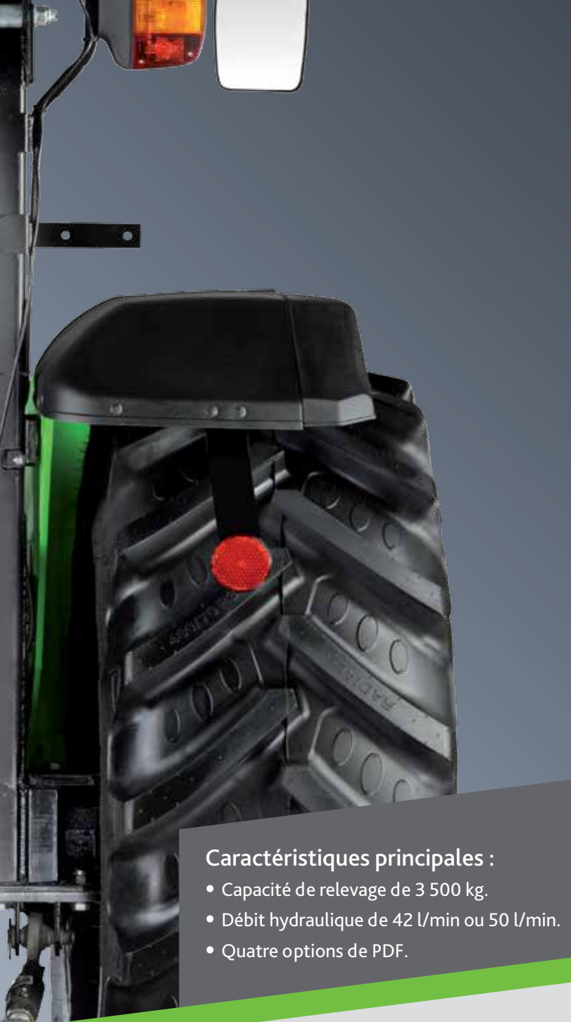
Relevage arrière avec attelages rapides de catégorie II et capacité de levage de 3 500 kg.
