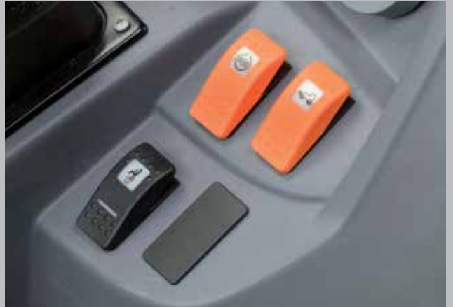
Possibilité d'activation mécanique ou électrohydraulique des 4 roues motrices et du blocage de différentiel.
