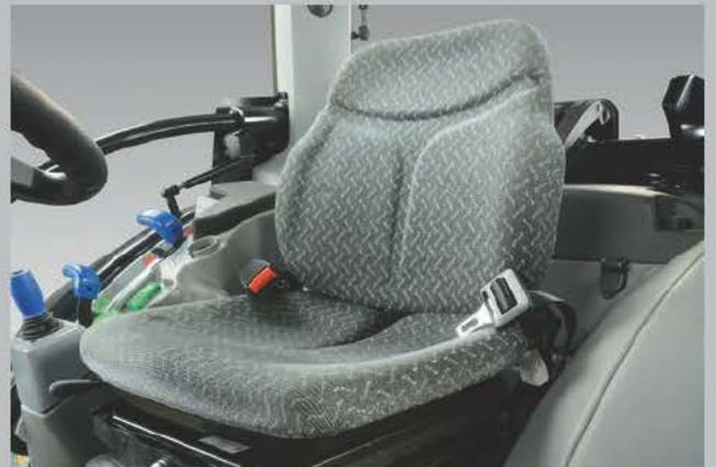
Siège disponible avec suspension mécanique ou pneumatique.
