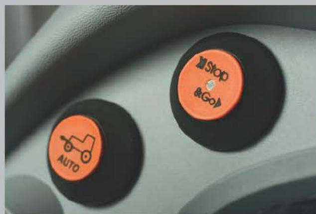
Stop&Go. Démarez et arrêtez votre véhicule avec confort, sans besoin d'enfoncer la pédale d'embrayage.
