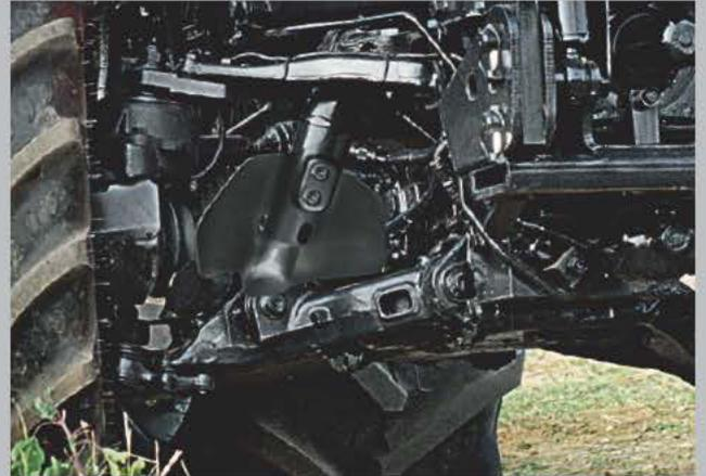
Suspension de roue indépendante à double triangulation.
