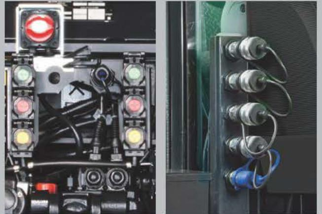
Jusqu'à six distributeurs à l'arrière et à l'avant.
