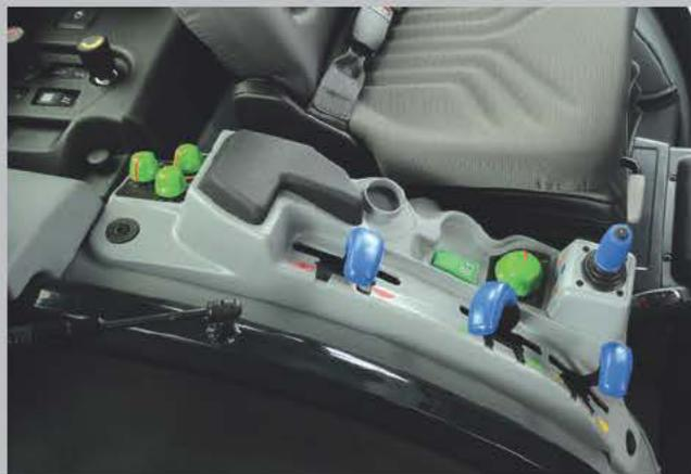
Commandes du relevage hydraulique arrière et des systèmes hydrauliques.
