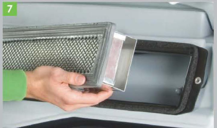
7 Le filtre à air dans la cabine empêche la pénétration de poussière et autres produits chimiques à l'intérieur du tracteur. Un air pur dans la cabine, tout le temps.
