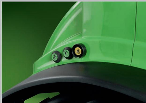
Le relevage arrière et la PDF sont commandés par des boutons situés dans les garde-boue.
