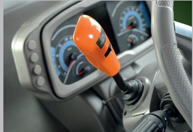
Le sens de marche peut être inversé à l'aide du levier d'inverseur de marche situé à gauche du volant. L'inversion peut-être adaptée aux conditions de travail en 5 niveau d'agressivité.
