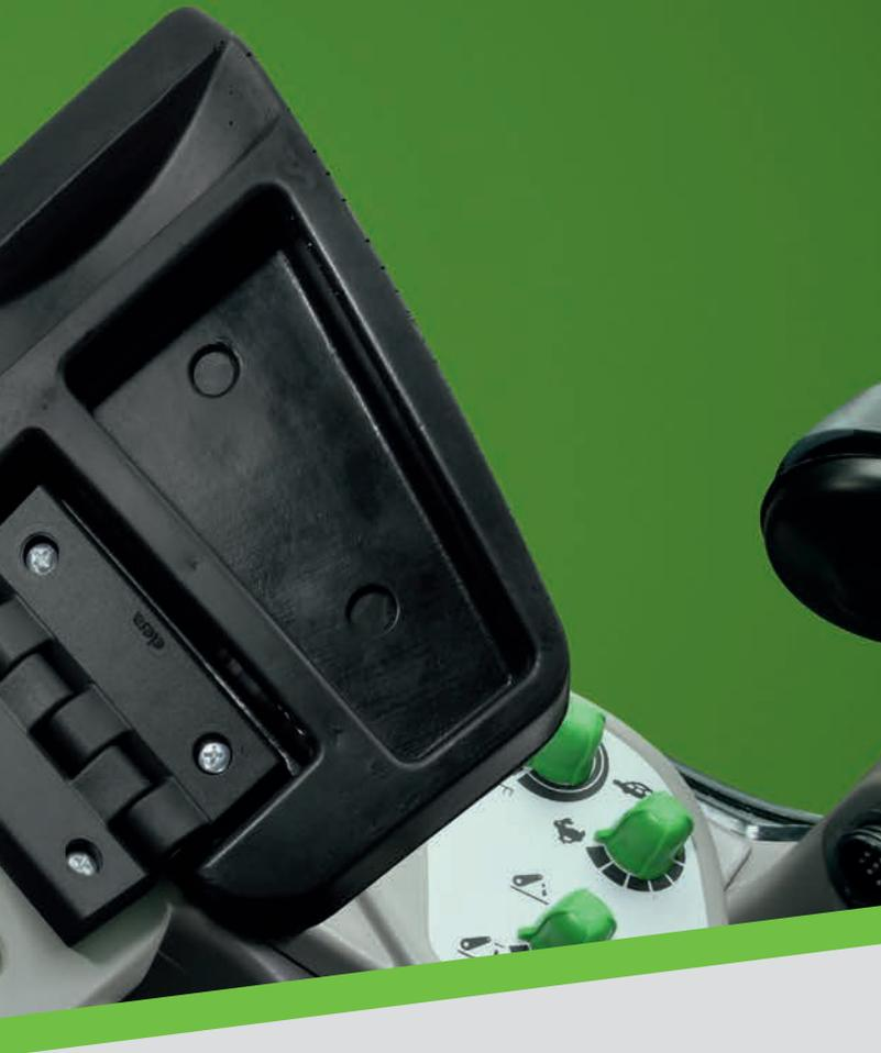
L'espace de travail a également été redessiné dans le but d'obtenir une position de travail optimale pour le conducteur. L'accoudoir multifonctions MaxCom au nouveau développement est intégré dans le siège du conducteur, avec un joystick ergonomique et des touches de fonction clairement structurées. Cela signifie que le conducteur confortablement installé peut contrôler depuis son accoudoir tous les travaux nécessitant le relevage avant, arrière et les attelages latéraux.
