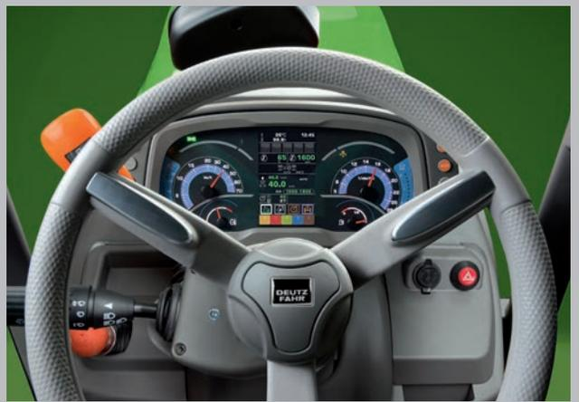
Le tableau de bord fournit au conducteur des informations numériques et analogiques en temps réel sur l'état de fonctionnement du tracteur.
