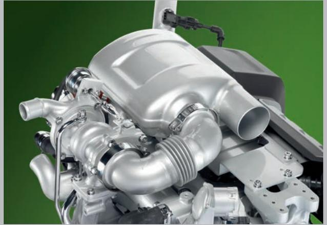
Système DOC breveté : la conception compacte abrite tous les filtres d'échappement sous le capot, sans ajout d'AdBlue.
