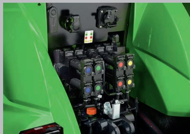
Jusqu'à cinq distributeurs électro-hydrauliques à double effet à l'arrière pour faciliter l'utilisation des attelages portés par le tracteur.
