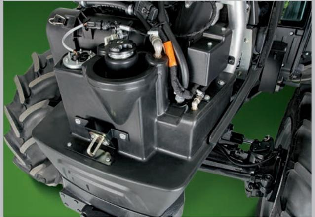
Le réservoir de carburant intégré dans le support du pont avant peut être rempli même avec le capot fermé, tandis que le réservoir auxiliaire se trouve en dessous.
