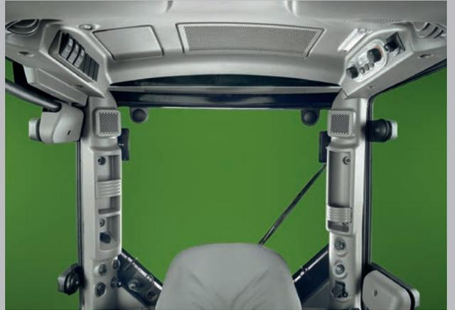
Les commandes de climatisation et Cat.4 sont intégrées dans le toit de la cabine et donc facilement accessibles.
