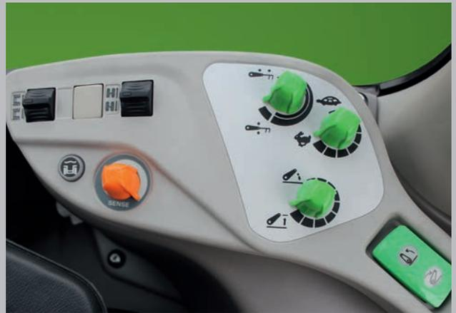
Potentiomètres rotatifs codés par couleur pour une manipulation et un fonctionnement intuitifs.
