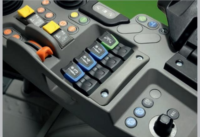
Commande précise des distributeurs auxiliaires et du relevage arrière à portée de main à l'aide d'interrupteurs manuels sur l'accoudoir MaxCom.
