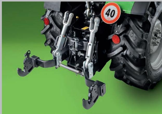
Relevage arrière à commande électronique avec une capacité de levage maximale de 3 800 kg (2 600 kg pour 5DV/5DS TTV).
