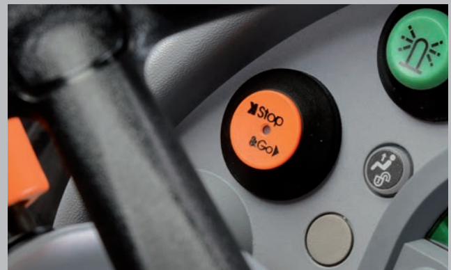
SYSTÈME STOP&GO : arrêtez et démarrez en n'utilisant que la pédale de frein.
