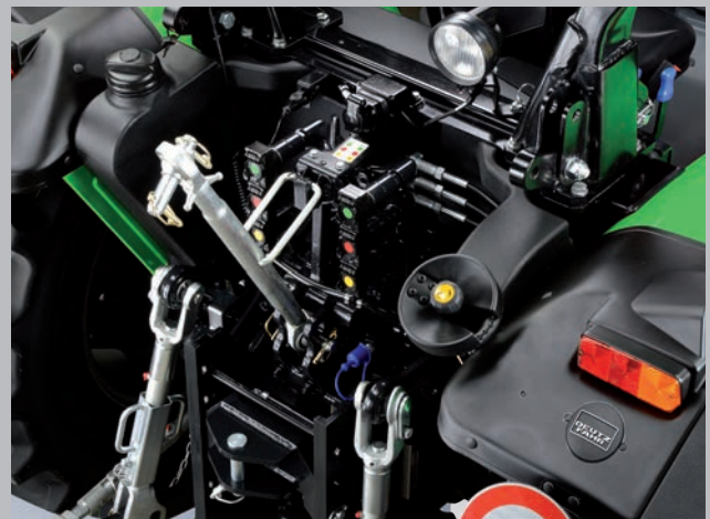
La pompe hydraulique de 55 l/min alimente jusqu'à trois unités de commande arrière.
