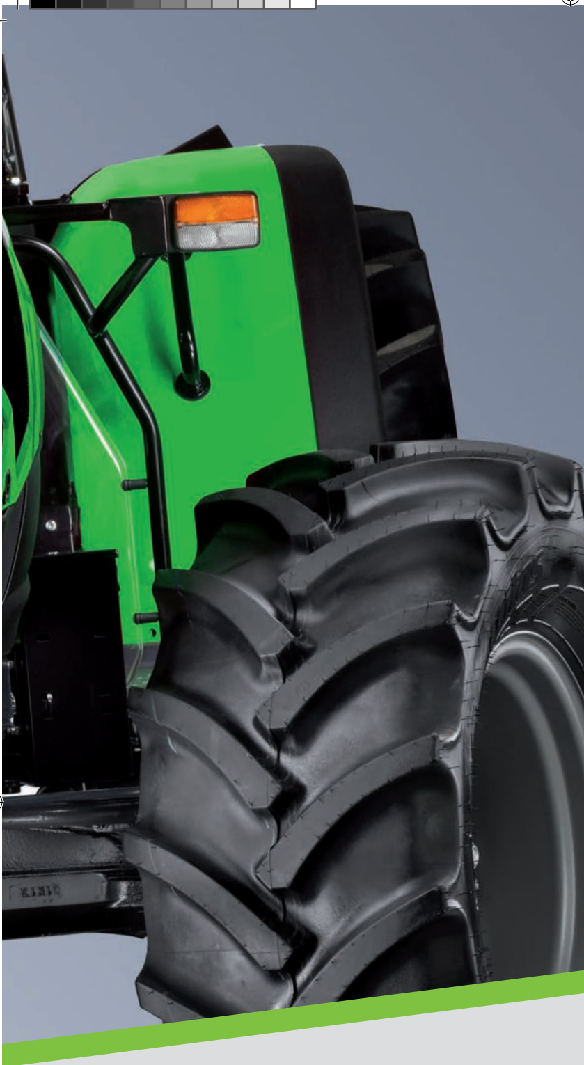
Pont avant : Angle de braquage de 50 degrés, 4 roues motrices électrohydraulique et activation du blocage de différentiel.
