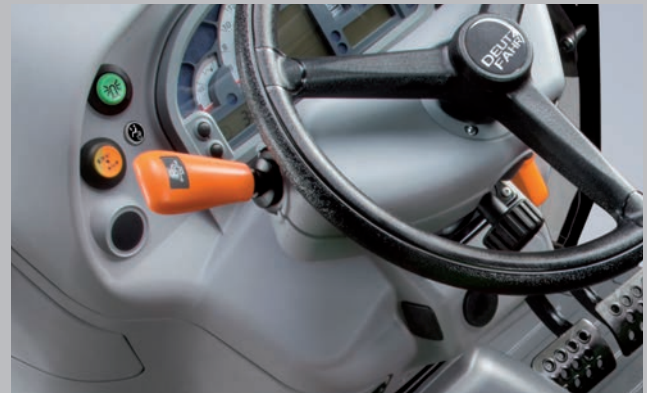
Système Powershuttle électrohydraulique : changez le sens de marche sans actionner l'embrayage.
