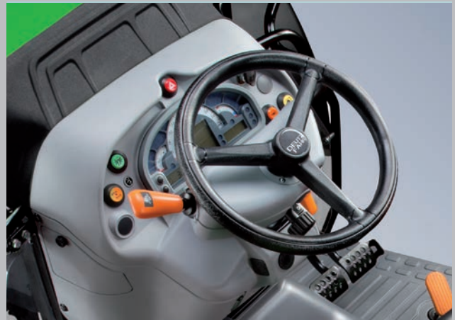
Le système de direction rapide et innovant SSD divise par deux le nombre de tours de volant pour l'angle de braquage complet.
