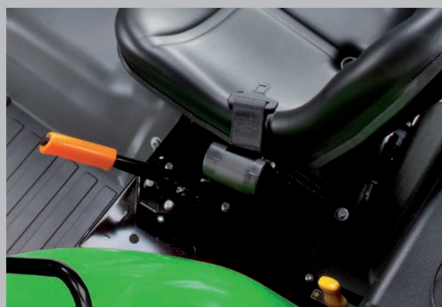
À gauche du conducteur : frein de stationnement et commandes de PDF.
