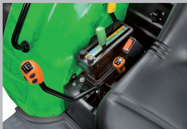
À droite du conducteur : Levier de vitesses, relevage arrière et unités de commande hydraulique ergonomiques.
