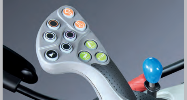
Les modèles TTV sont commandés à l'aide du nouveau joystick PowerCom S. Quatre boutons peuvent être affectés à une quelconque fonction.
