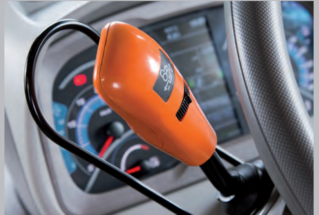
Inverseur SenseClutch électrohydraulique pour des changements de direction précis et sûrs pendant la conduite et sous charge sans interruption de couple.
