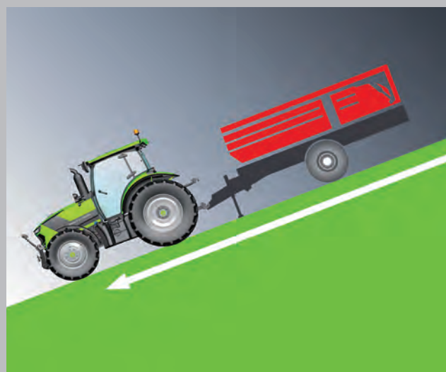
Un frein de remorque hydraulique ou pneumatique assure un déplacement sûr en cas de charges lourdes.
