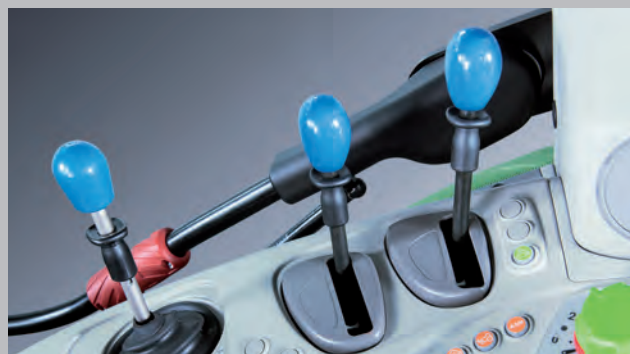
Commande mécanique ou électrohydraulique de l'outil. Le choix vous appartient.
