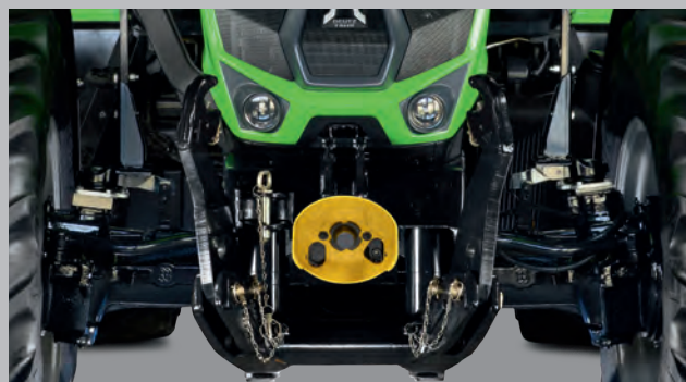
Le relevage avant peut lever jusqu'à 2 880 kg. Également disponible : ComfortPack avec une vanne de régulation supplémentaire à l'avant.
