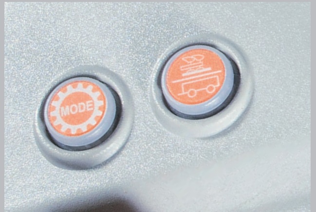
Le mode travail (CHAMPS/TRANSPORT) est sélectionné par commande électrohydraulique.
