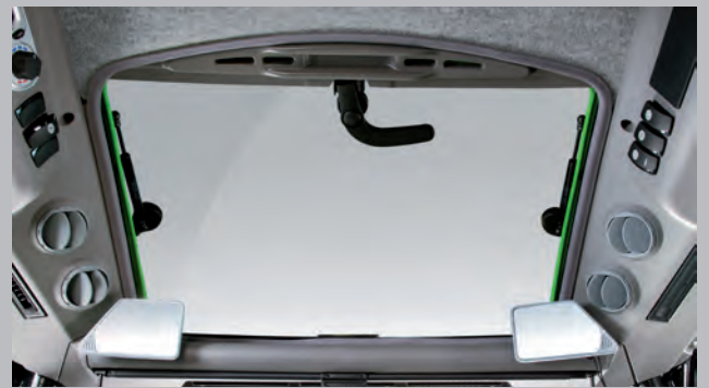
Une sélection de quatre modèles de toit : un toit ouvrant transparent avec ou sans FOPS et un toit opaque avec ou sans FOPS.
