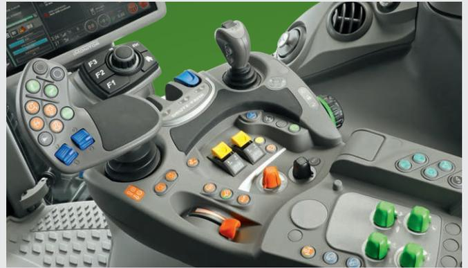
RCshift : Disponible en variante avec commande de distributeurs mécanique ou en variante avec accoudeur multifonction, distributeurs électro-hydrauliques et iMonitor.
