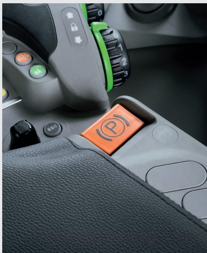
↑ Sur les modèles TTV, l'EPB remplace le levier de frein à main mécanique et est actionné par le biais d'une commande électrique à bouton-poussoir sur la console de l'accouoir.
