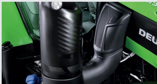
↑ Traitement SCR des gaz d'échappement et FAP passif, la solution la plus efficace en termes de puissance moteur, de consommation de carburant et de coûts d'exploitation.
