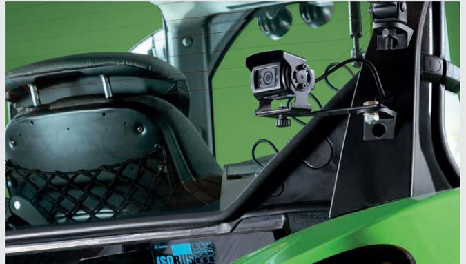
↑ Caméra intégrée avec mode plein écran automatique (par ex. en marche arrière) pour une vue d'ensemble et la sécurité.
