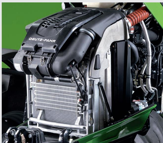
↑ Technologie PowerCore pour filtre à air : 20% de capacité de débit d'air supérieure par rapport aux filtres standard.
