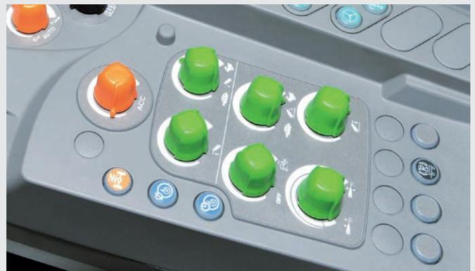
Le relevage avant (TTV uniquement) et le relevage arrière peuvent être réglés avec précision à l'aide du potentiomètre sur l'accodoir.
