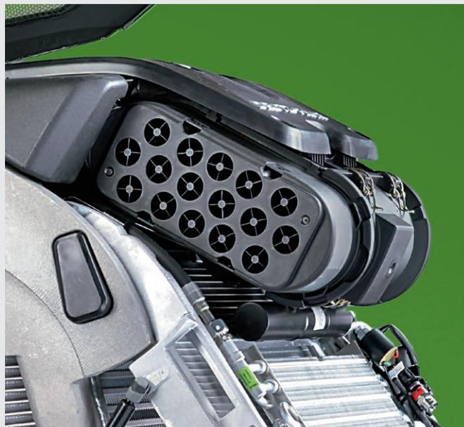
↑ Système de pré-nettoyage dans le filtre à air du moteur : les tuyaux cyclones en spirale et les tuyaux aspirateur éliminent 95 % des poussières avant qu'elles n'atteignent le filtre primaire.
