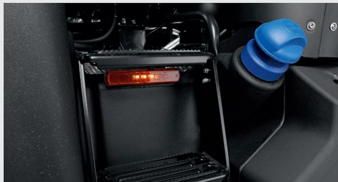
↑ Consommation de carburant/AdBlue réduite : Jusqu'à 400 l de diesel et 50 l d'AdBlue pour le 6 cylindres, 225 l de diesel et 28 l d'AdBlue pour le 4 cylindres en vue de journées de travail plus longues et plus faciles.
