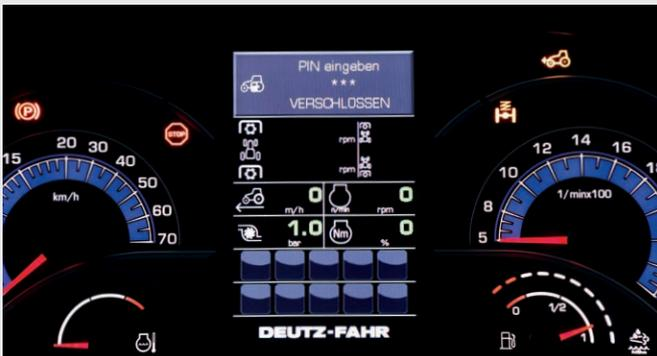
↑ Tableau de bord ultramoderne avec InfoCentrePro : Écran couleur 5" haute résolution pour un concept d'informations personnalisables au plus haut niveau. Le verrouillage par code dans le tracteur assure la sécurité - verrouiller et déverrouiller avec un code PIN.
