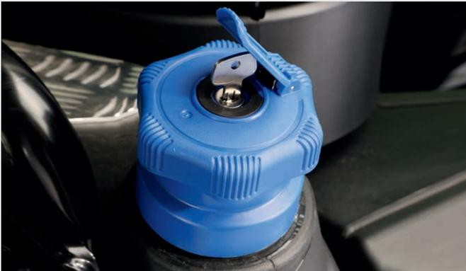
↑ Couverts verrouillables pour réservoirs de carburant et AdBlue.
