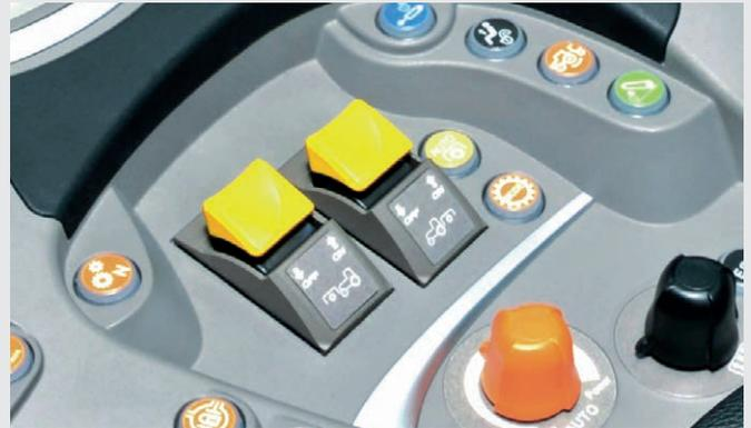
La commande de la PDF est facile et fiable à actionner à l'aide d'un bouton-poussoir sur toutes les variantes de cabine.
