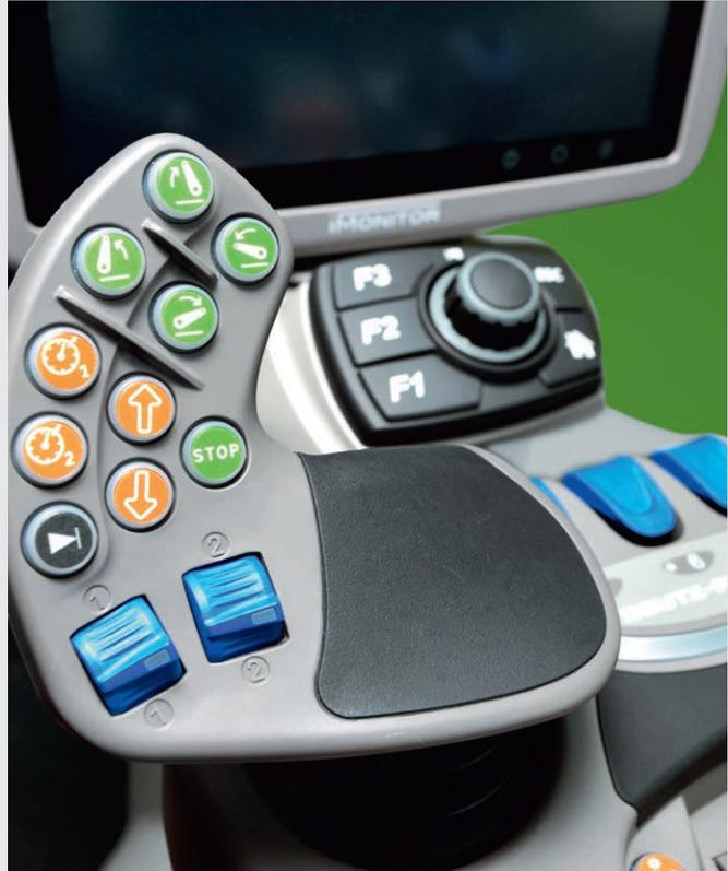
↑ Avec deux boutons sur le joystick multifonctions MaxCom, le conducteur peut utiliser quatre vitesses différentes pour travailler sur le champ ou sur la route et maintenir une vitesse constante pour un résultat optimal.
