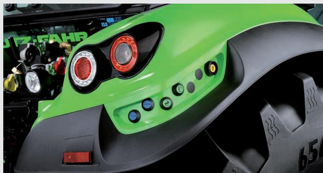
↑ Commande simple du système hydraulique, du relevage arrière et de la PDF de l'extérieur de l'un ou l'autre côté.
