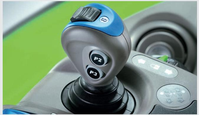
Les distributeurs hydrauliques sont équipés d'une commande proportionnelle et peuvent être entièrement programmés en fonction du temps et du débit. La joystick électronique peut être programmée pour commander le chargeur frontal tandis que d'autres distributeurs sont actionnés à l'aide de la molette.
