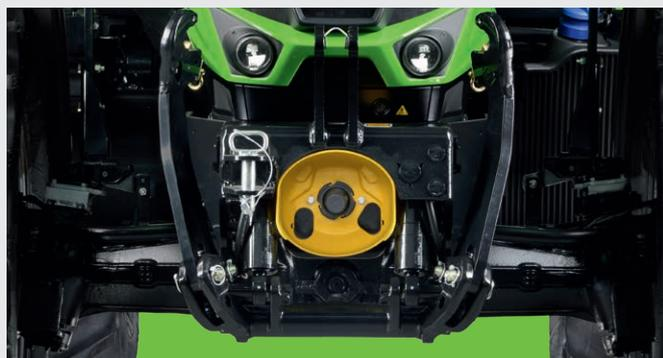
↑ Relevage avant à position contrôlée avec une puissance de levage allant jusqu'à 5480 kg (modèles TTV).
