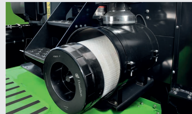
↑ Pas besoin d'outils pour remplacer le filtre à air.
