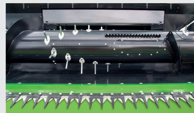
↑ La vis d'alimentation à spirales et doigts de grandes dimensions assure le passage constant du grain.
