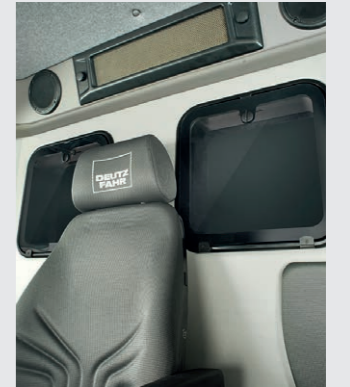
Double hublot d'inspection de la trémie.
