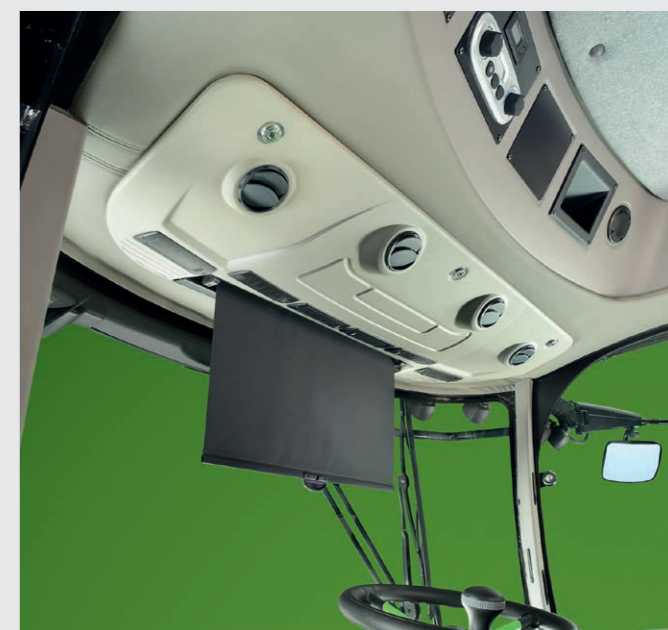
Le système de ventilation innovant avec climatisation à haute efficacité et pare-soleil autobloquant.
