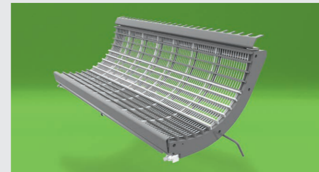
Le contre-batteur avec différents espacements ou avec le système unique à segments.
