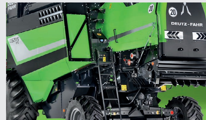
↑ Accès facilité à la partie supérieure de la moissonneuse-batteuse ainsi que pour le ravitaillement en Diesel et AdBlue.
