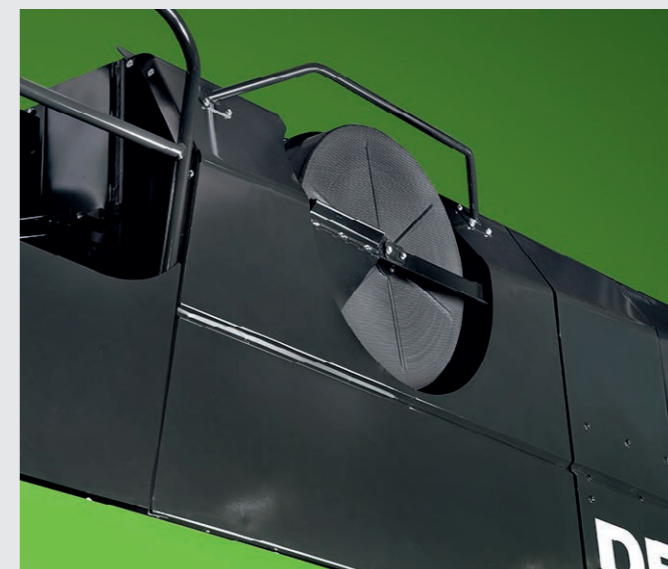
↑ Un grand tamis rotatif assure un rendement maximum au système de refroidissement.
