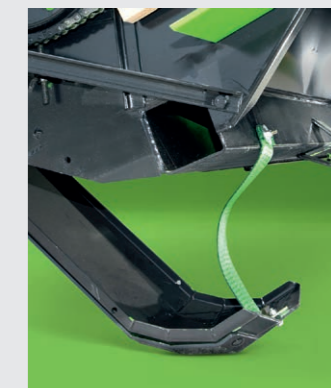
↑ Patins palpeurs fiables et robustes pour le système Autocontrol.
