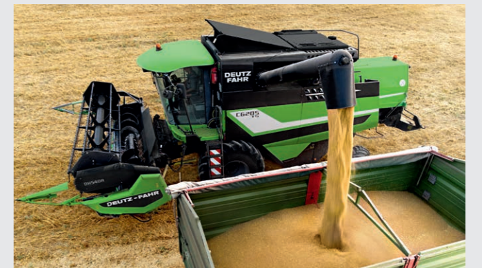
Tube de déchargement pour décharger dans toutes les conditions de travail.
