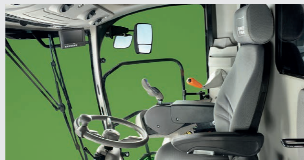
↑ Siège ergonomique avec réglage mécanique ou pneumatique, colonne de direction réglable pour régler le siège dans une position de conduite confortable.
