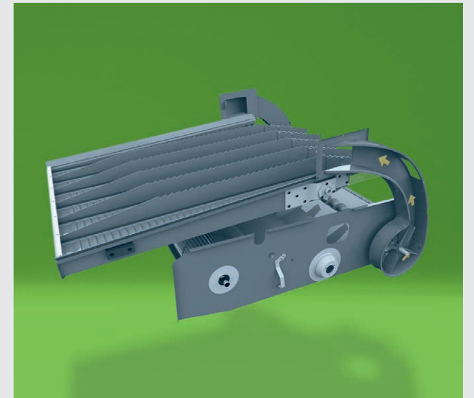
Le système de double retours à ôtons DGR renvoie le produit sur la table de préparation en flux croisé.
