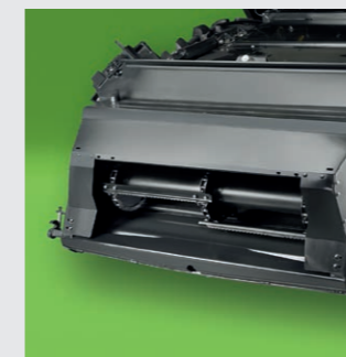
↑ La largeur du convoyeur favorise le système de battage lorsque les rendements sont importants.
