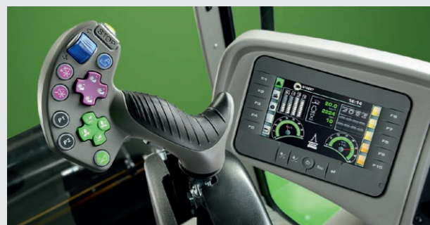
↑ COMMANDER STICK. Orientation du joystick multifonction permettant une prise en main facile.
