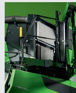
↑ Accès pour le nettoyage des radiateurs.
