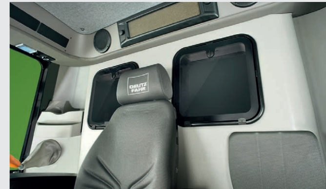
↑ Surveillance visuelle de la trémie à grain. Une fenêtre double en cabine permet de contrôler le niveau de remplissage de la trémie et la qualité du grain moissonné.
