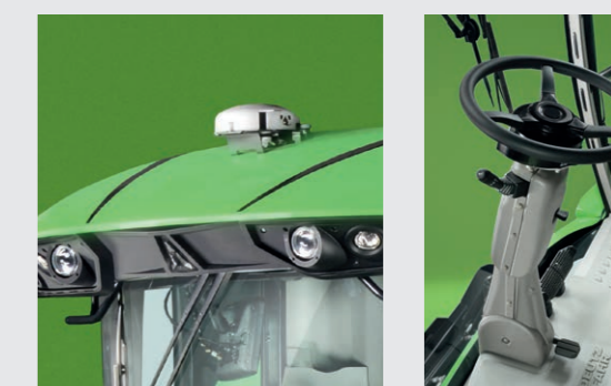
Installation facile des systèmes de Precision Farming, intégration complète de la direction électrique, de l'antenne GPS, des capteurs de rendement et de l'ECU Isobus.
