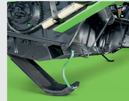
↑ Les patins palpeurs permettent à la barre de coupe de suivre parfaitement les irrégularités du terrain et de corriger instantanément toutes les ondulations.
