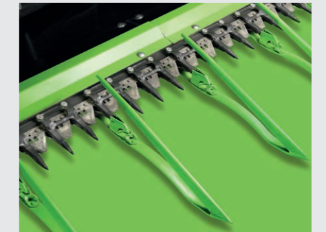
↑ Les sections montées en position alternées réduisent l'usure et garantissent toujours une coupe parfaite.
