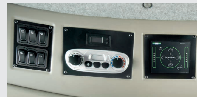
↑ La technologie Balance permet la compensation des dévers jusqu'à 20% latéralement et 6% dans le sens de marche. La moissonneuse-batteuse est automatiquement maintenue à l'horizontale.
