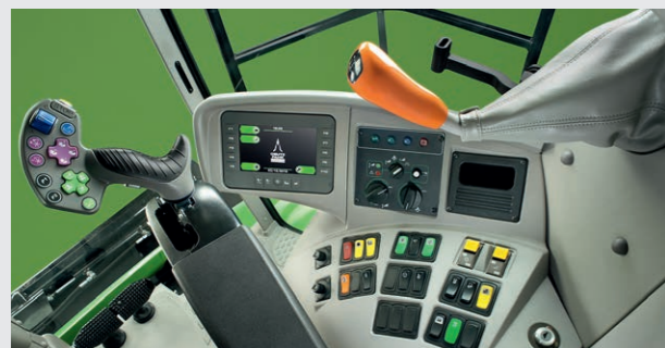
↑ L'ordinateur de bord TERA7 permet d'effectuer simplement et intuitivement tous les réglages de la moissonneuse-batteuse.
