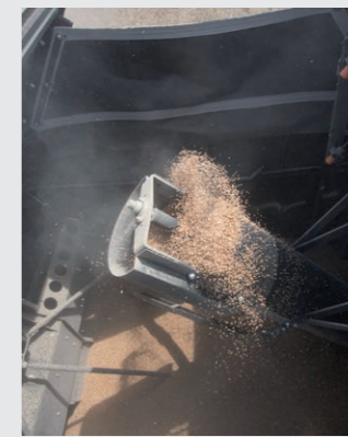
↑ Trémie à grain. Caisson à grain volumineux.
