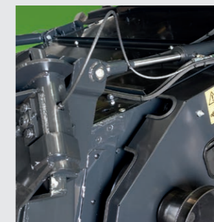
↑ Le réglage de l'angle de coupe permet une adaptation parfaite aux irrégularités du terrain.
