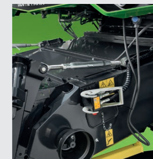
↑ Le réglage de l'angle de coupe permet une adaptation parfaite aux irrégularités du terrain.
