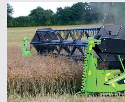
↑ L'équipement colza peut être monté à la barre de coupe pour céréales pour gagner en polyvalence.
