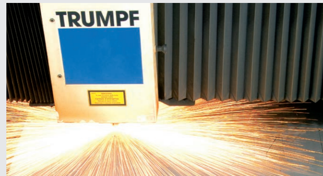
Chaque élément de la structure de la machine est sectionné à la découpeuse laser, qui en partant du dessin en 3D, aboutit à la pièce finie.
