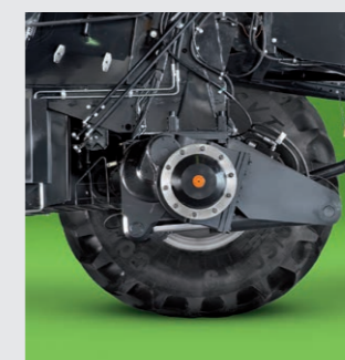
↑ Les réducteurs d'une portée de 25 t permettent de travailler dans les conditions les plus extrêmes.
