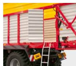
Porte d'accès latérale avec échelle
