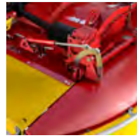
Repliage hydraulique des protections latérales
