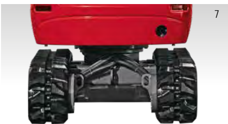
LARGEUR DU TRAIN DE ROULEMENT RÉTRACTÉ 980 MM
