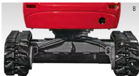
LARGEUR DU TRAIN DE ROULEMENT DÉPLOYÉ 1 300 MM
