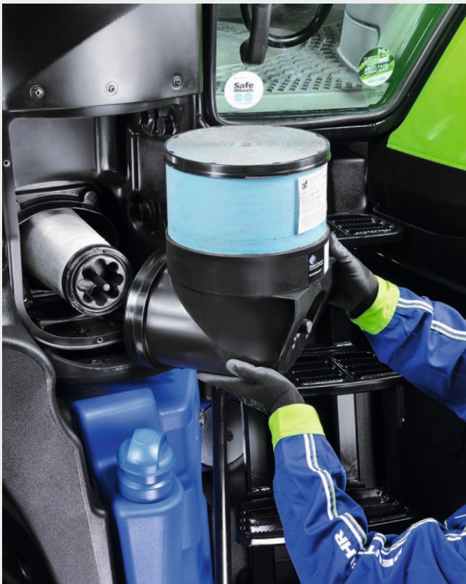
↑ Le filtre à air du moteur est facile à insérer et à enlever.
