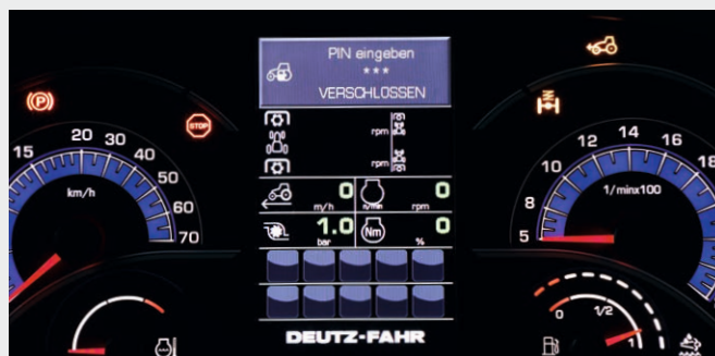
↑ Le nouvel InfoCenter garde le chauffeur informé sur l'état de fonctionnement du tracteur. Sécurité grâce au verrouillage par code du tracteur. Verrouillage et déverrouillage par code PIN.
