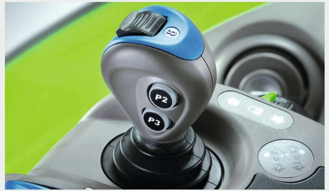
Le joystick en croix commande trois distributeurs hydrauliques.
