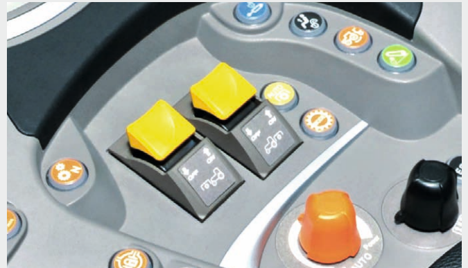
Quant à la PDF, elle se règle et s'actionne aisément depuis l'accoudoir...
