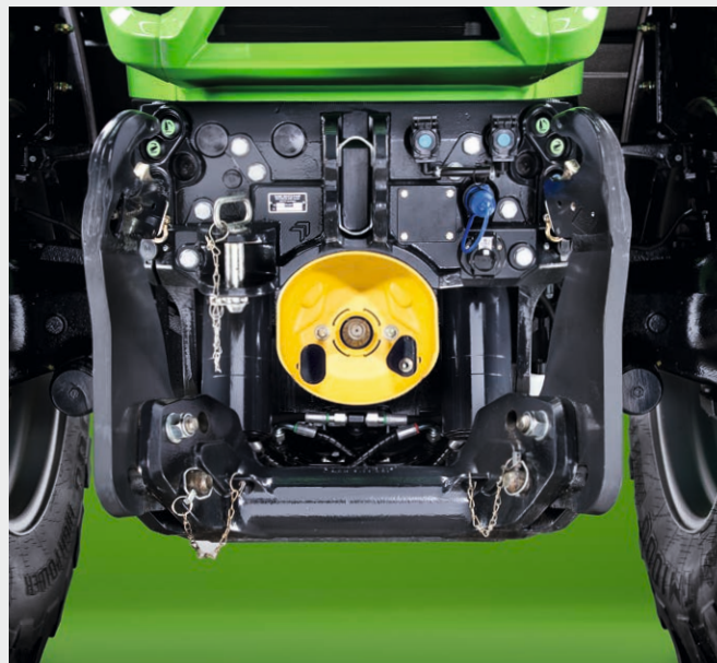
Un relevage avant intégré avec une courte distance unique en son genre par rapport au pont avant. Porte-à-faux bas. Meilleur équilibre du tracteur.
