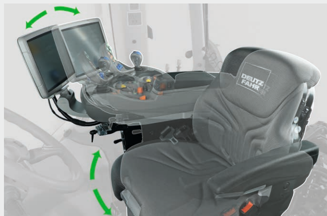
↑ Maintenant disponible pour tous les modèles TTV : Siège pivotant jusqu'à 20° pour plus de confort et de facilité d'utilisation.
