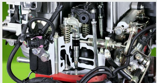
↑ Technologie DCR : Une pression d'injection de 2000 bars pour une performance maximale du moteur.
