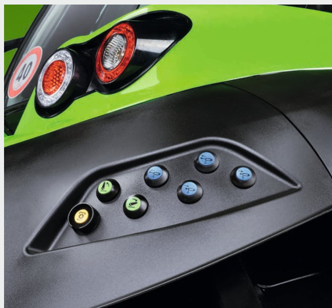
Commande externe des fonctions hydrauliques et de PDF des deux côtés.
