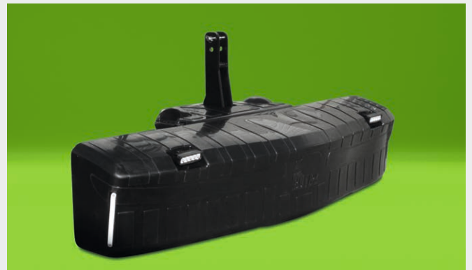
↑ Lestage avant en fonte jusqu'à 2500 kg.
