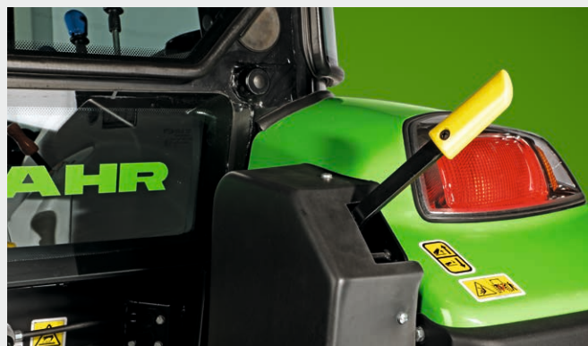
Une commande extérieure du relevage arrière est disponible en option.
