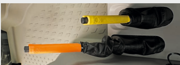
↑ Commandes mécaniques pour la sélection du régime de PDF et l'engagement de l'embrayage de PDF.
