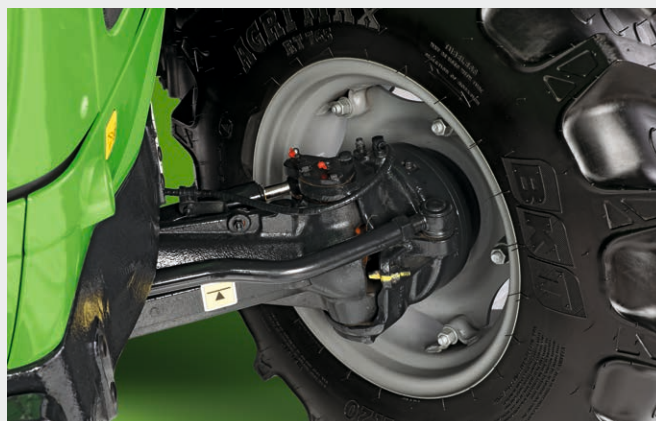
↑ Pont avant directeur à un angle de braquage jusqu'à 55°.
