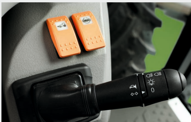
↑ Activation électrohydraulique du blocage du différentiel et des 4RM.
