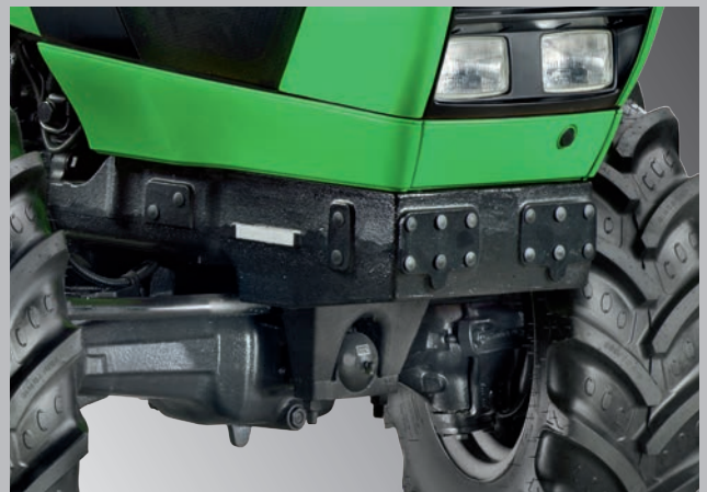
Véritable système de freinage des quatre roues avec freins à disque humide sur le pont avant, pour une sécurité maximale sur le terrain comme sur la route.
