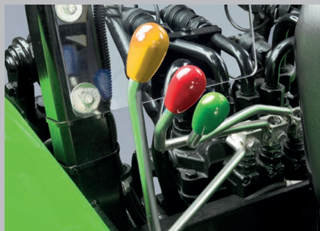
Équipé d'un maximum de trois distributeurs de contrôle mécaniques alimentées par une pompe à cylindrée fixe d'une capacité de 42 l/min.
