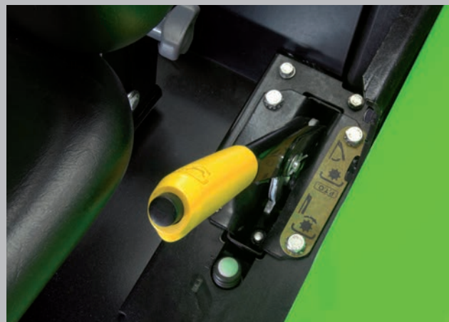
Changement de PDF confortable et doux à l'aide d'un levier de commande mécanique. Jusqu'à deux vitesses de PDF (540/540 ECO).
