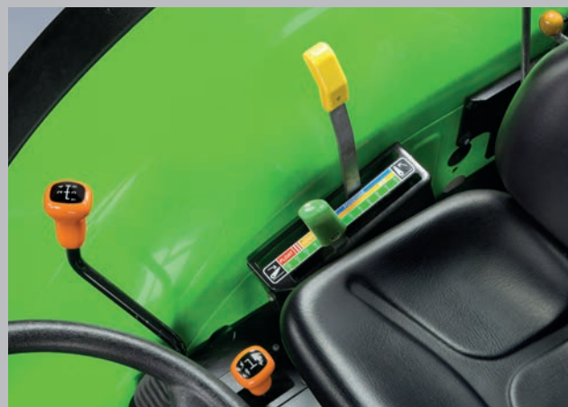
Commande de vitesse de relevage mécanique – un relevage précis et facile à utiliser.
