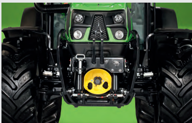
↑ Le pont avant est équipé de série de deux disques intégrés à bain d'huile.
