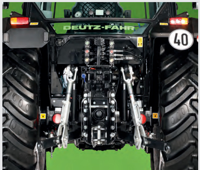
↑ Le relevage arrière de la série 5D est disponible aussi bien avec les attelages rapides qu'avec les chandelles.
