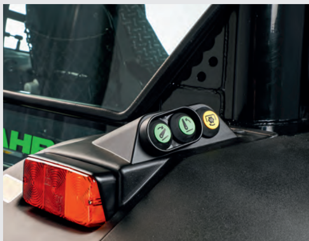
↑ Commandes pratiques pour le relevage arrière et la PDF sur le garde-boue arrière.
