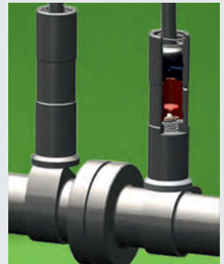
↑ Le réglage automatique du jeu des soupapes réduit les niveaux sonores et est dépourvu d'entretien.
