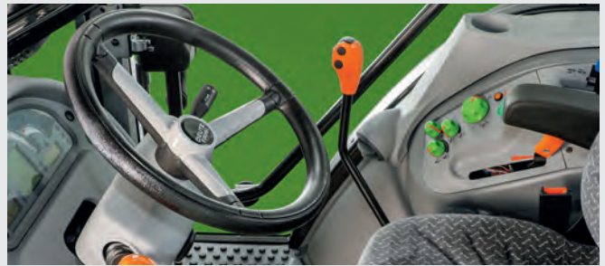
↑ Le volant télescopique et inclinable s'adapte librement au conducteur.
