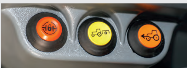
↑ Le fonctionnement de la PDF électrohydraulique garantit un engagement confortable et un démarrage en douceur de la prise de force.
