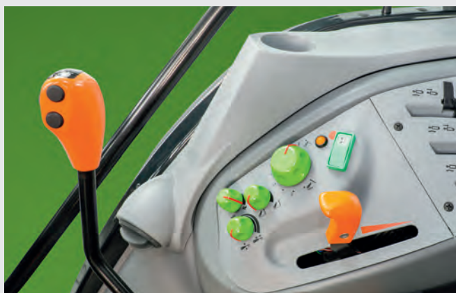
↑ Levier de vitesse confort pour la transmission 45+45 rapports avec boutons latéraux pour le changement des rapports sous charge.
