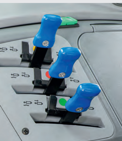
offrant jusqu'à 3 commandes auxiliaires mécaniques, ergonomique sur la console latérale.
