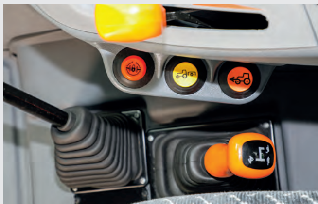
↑ Engagement électrohydraulique des 4RM et du blocage de différentiel (LS et GS).
