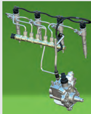
↑ Le système à rampe commune d'injection assure une combustion hautement efficace du carburant.
