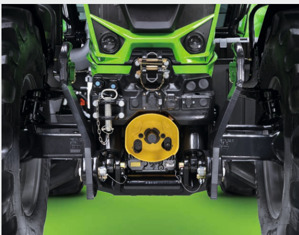
↑ 5 distributeurs proportionnels à l'arrière et 2 à l'avant. Relevage avant plus proche et intégré au tracteur
