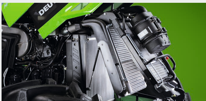
↑ Nouvelle conception du circuit de refroidissement (Aluminium). Ouverture intégrale pour un entretien facile.
