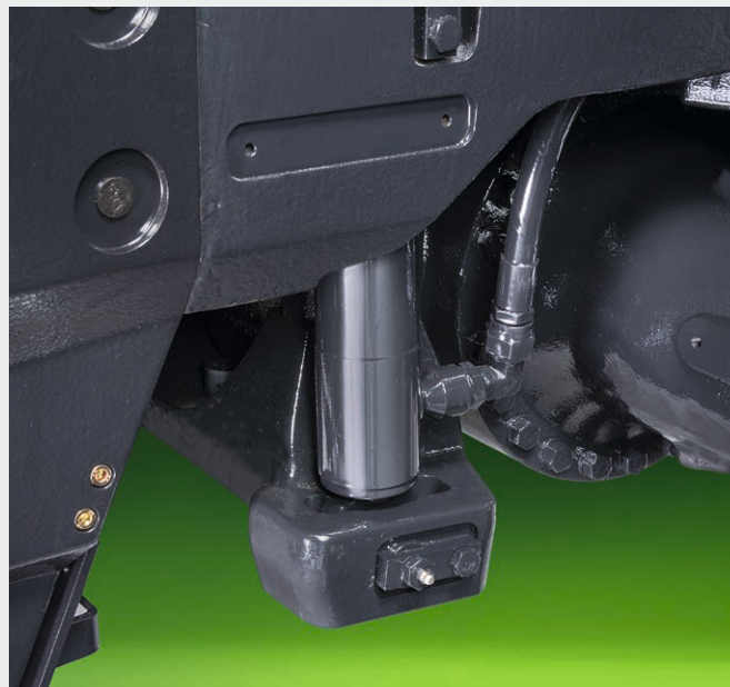
↑ Concept de suspension unique du pont avant heavy duty.
