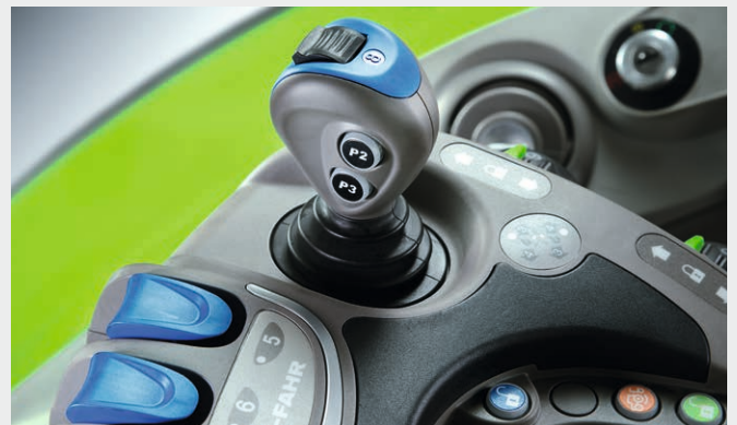
↑ Les distributeurs hydrauliques sont commandés par un joystick avec smartwheel incorporé.
