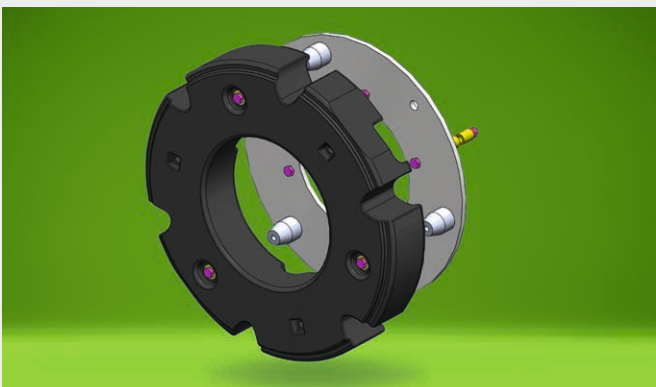
↑ Masses sur les jantes avec un poids de lestage pouvant atteindre 1840 kg.
