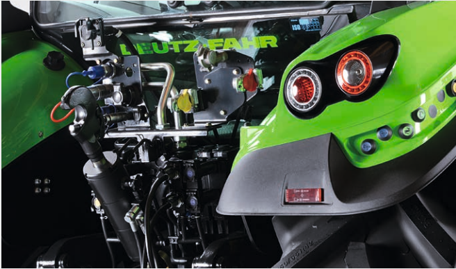
↑ Le système de freinage hydraulique + pneumatique.
