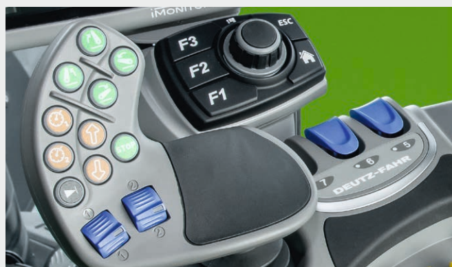
↑ Jusqu'à 4 vitesses de croisière peuvent être mémorisées et rappelées pour optimiser les processus de travail.
