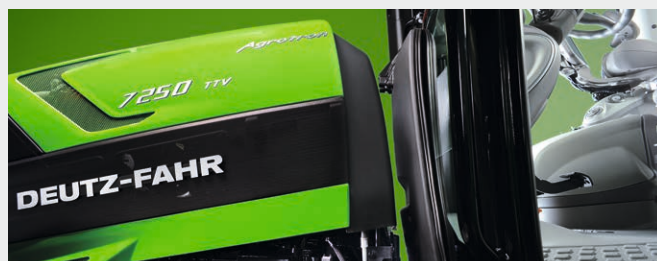
↑ La cabine et le capot sont séparés pour réduire le bruit et les vibrations et augmenter le confort.
