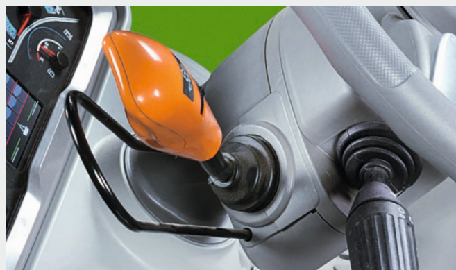
↑ Inverseur et SensClutch, les 5 niveaux de sensibilité d'inversion se règlent facilement.
