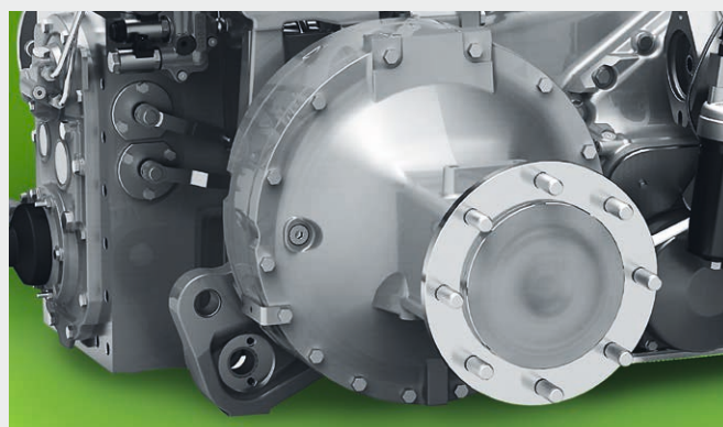
↑ Inverseur hydraulique doté de deux embrayages multi disque à bain d'huile et d'un boîtier électronique de commande.
