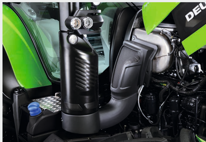
↑ Le traitement SCR des gaz d'échappement et le FAP passif permettent d'économiser du carburant et des coûts d'exploitation.
