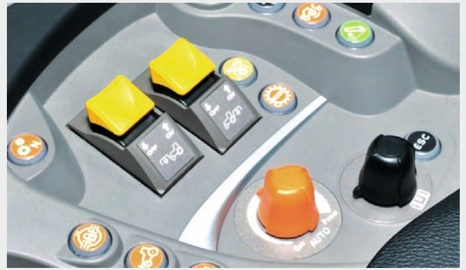
↑ L'activation et l'enclenchement de la PDF (avant/arrière) sont intégrés dans l'accodoir ...
