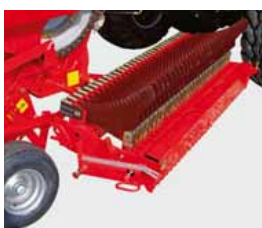
Pivotement latéral de la barre de coupe
