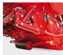
Rouleau de jauge arrière pour pick-up
