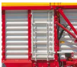
Porte d'accès latérale avec échelle
