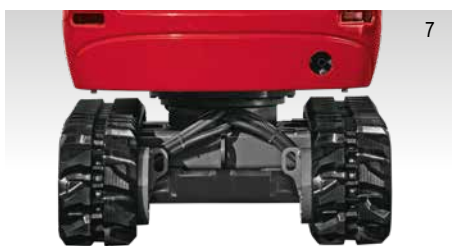
LARGEUR DU TRAIN DE ROULEMENT RÉTRACTÉ 980 MM
