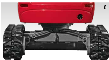
LARGEUR DU TRAIN DE ROULEMENT DÉPLOYÉ 1 300 MM
