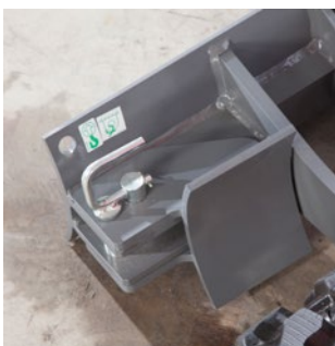
La lame s'élargit manuellement
