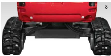
LARGEUR DU TRAIN DE ROULEMENT DÉPLOYÉ 1500 MM
