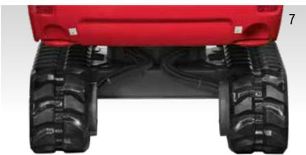
LARGEUR DU TRAIN DE ROULEMENT RÉTRACTÉ 1100 MM
